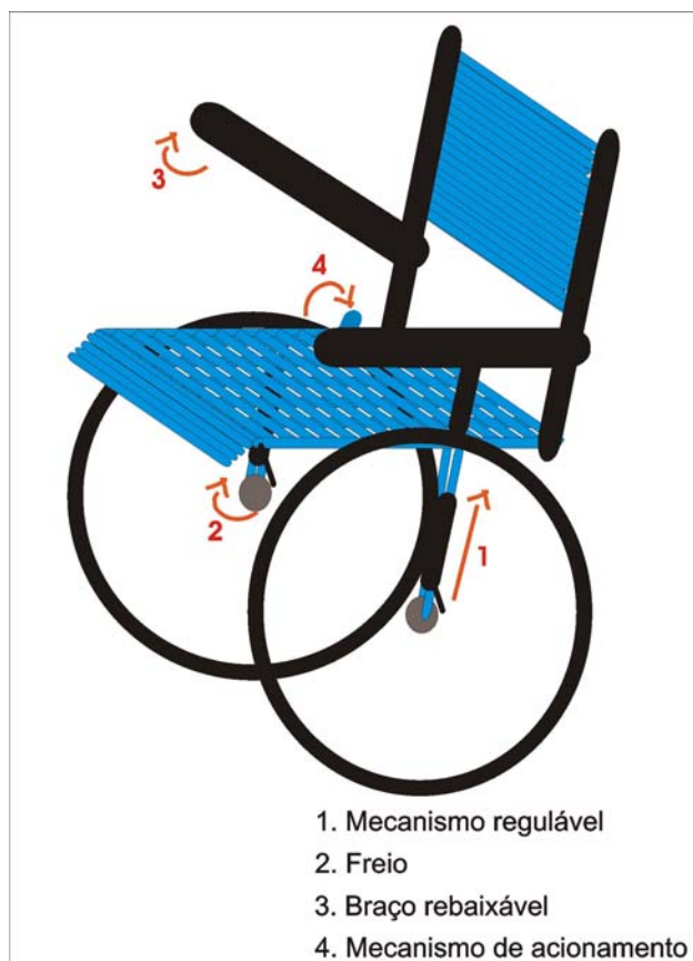
Figura 1. Proposta de cadeira de rodas para minimizar os esforços durante a manipulação de pacientes.
