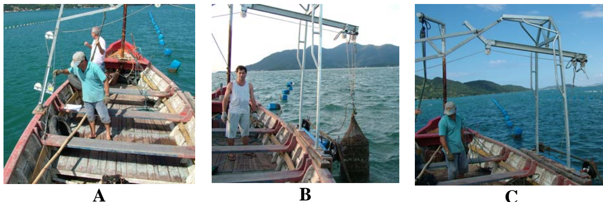
Figura 04 – (A) mudança da posição e modo de exercer a força com postura adequada – (B) Elevação da estrutura de cultivo através de um sistema de cabos e polias com redução de esforço – (C) Vista geral do protótipo desenvolvido para testar o conceito do sistema.
