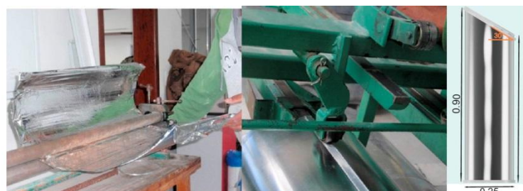
Figura 4 – Tubo de aluminio para el transporte de luz
