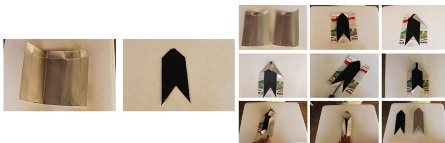
Figura 1 – Molde para a dobradura das caixas de Tetra Pak®
