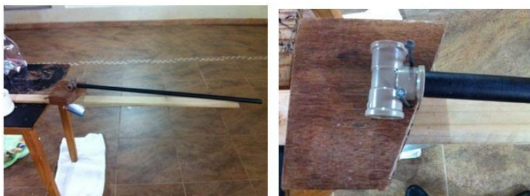
Figura 4 – Encaixe para o cano de PVC
