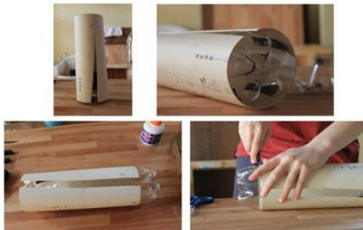
Figura 2 – Molde para corte da garrafa PET
