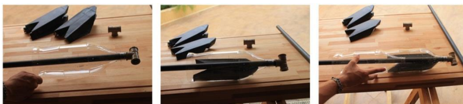
Figura 5 – Montagem das caixas Tetra Pak nas garrafas PETs
