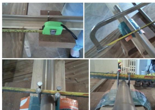
Figura 3 – Corte dos tubos de PVC
