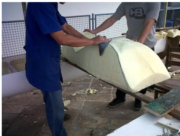
Figura 4. Fase de finalização do molde para fabricação do assento
